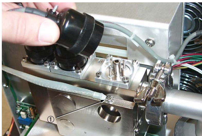
Figura 4-3 Extracción de los Conectores
