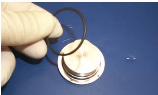
Figura 4-18 Extracción de la Junta Tórica de la Pieza del Polo Magnético
