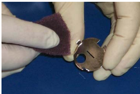
Figura 4-20 Placa Ranurada de Tierra Descolorida
