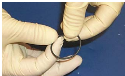
Figura 4-23 Inspección de la Junta Tórica
